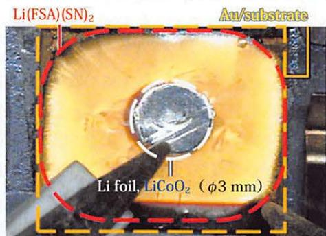
図6 作成した全固体電池の外観
