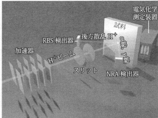
図1 RBS, NRA 測定装置の概要
