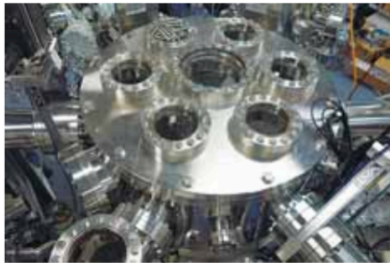
デジタルラボの中核。中央の円形部分に試料を扱うロボットが入っており、6本のパイプはそれぞれチャンバーにつながっている。
